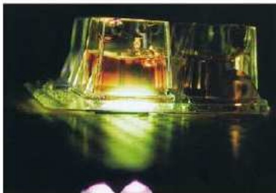
Figura 1 Procedimiento de irradiación con un diodo de UVA doble, bajo los recipientes de la placa de cultivo.
